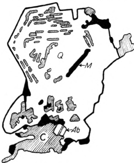
Abb. 6. Quarz, teilweise idiomorph begrenzt, mit orientiert eingelagertem Calcit. (Salband von Gang f.) Schliff 264 a. Q = Quarz, C = Calcit, Ab = Albit, M = Magnetit. Vergrößerung 110fach.
