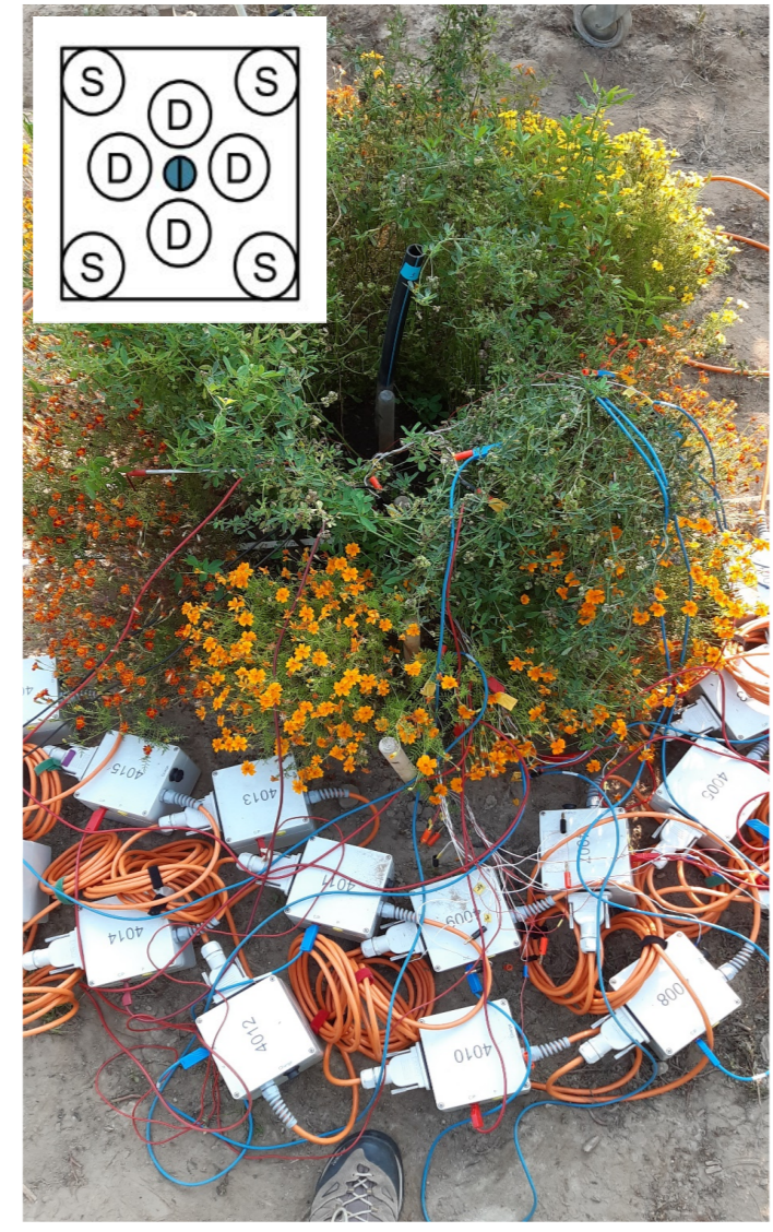
Abb. 1 Bohrlochsetup; Inlay: Bepflanzung. S: Flachwurzler, D: Tiefwurzler, blau: Schlauch Abb. 2: Versuchsfeld mit Elektroden für Oberflächengeoelektrik
