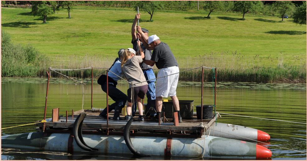
Abb. 3: Stechrohrbohrung: eine Verlängerungsstange wird durch die Bohrmannschaft nach unten gedrückt. Demontierbare Bohrplattform auf zwei verankerten Treibstofftanks des Düsenjägers RF86, Hüttensee/westl. Allgäu, am 11. Mai 2015 (Foto W. Hohl)
