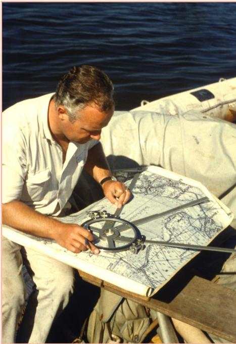
Abb. 4: Helmut Brandes im Bohr-Schlauchboot findet mit dem dreischenkigen Zulegegerät auf der Karte des Bederkesaer Sees die Position einer Bohrung auf dem See, August 1967 (Foto J. Merkt)
