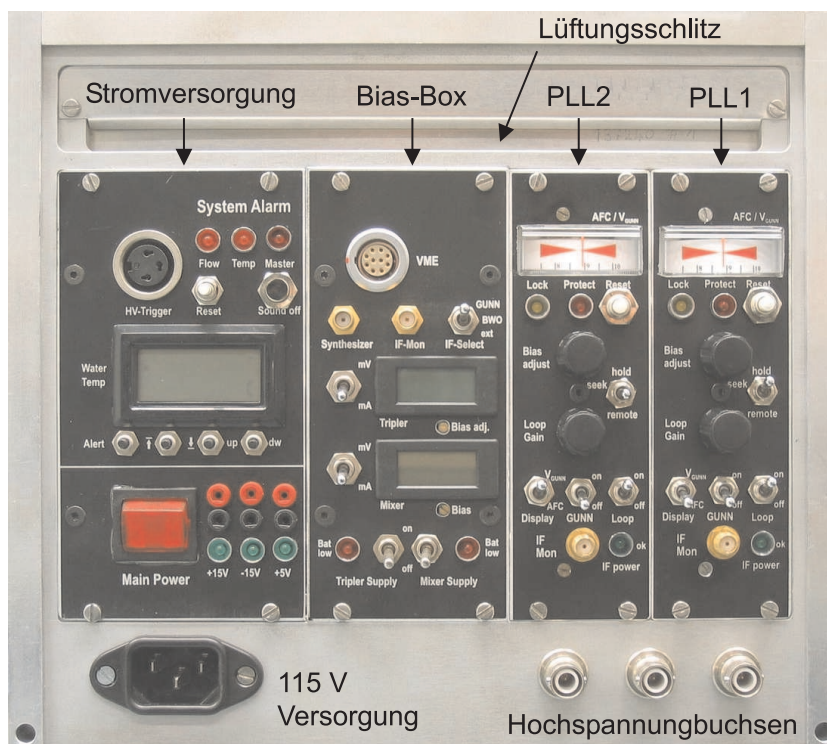
Abbildung 4.20: Frontansicht des 1,9 THz Oszillators. Im oberen Bereich ist der Luftauslassschlit zu erkennen, im unteren Bereich befinden sich die Buchse für die Stromversorgung der Box sowie die Hochspannungsanschlüsse für den BWO. Die Elektronikeneinschübe des LOs sind entsprechend benannt.
