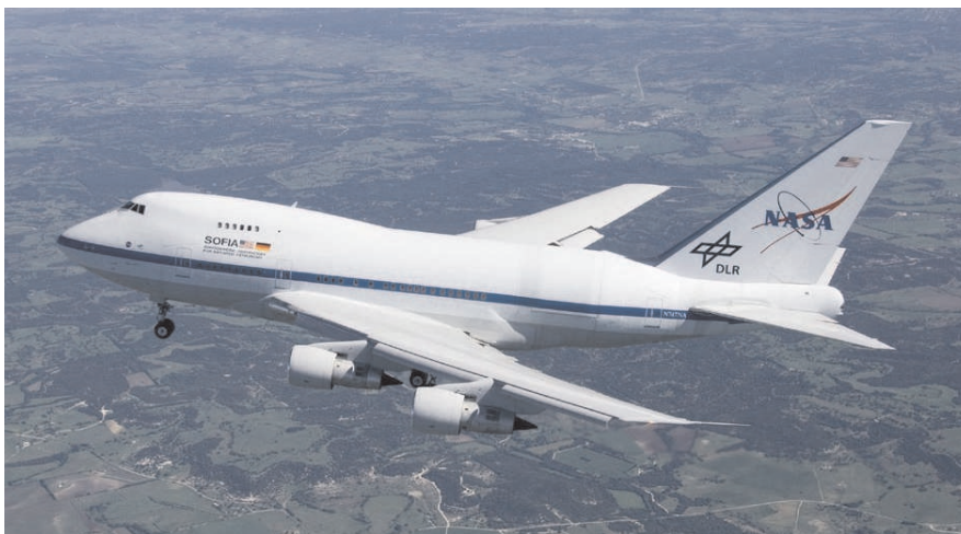
Abbildung 1.4: SOFIA während des ersten Testfluges nach dem Umbau durch die Firma L-3 Communications Integrated Systems in Waco, Texas am 26 April 2007. Das Teleskop befindet sich im hinteren Teil des Flugzeugrumpfes hinter dem (hier geschlossenen) Teleskopschott.
