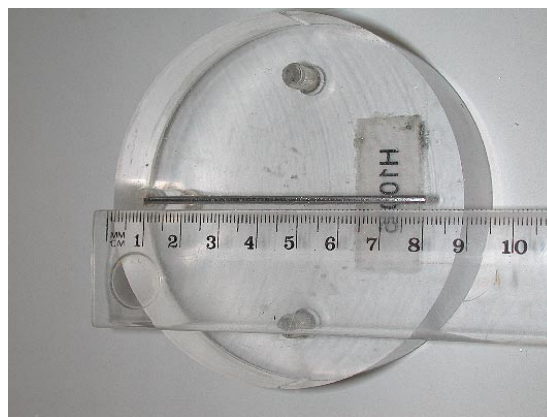
Abb. 3-40: Aufbau einer Halbraumlinienquelle für Standardanwendungen. Eine Nadelsonde ist bündig in die Oberfläche eines Plexiglashalbraums eingelassen. Die Zuleitungen für Heizspannung und Temperaturmessungen befinden sich an der Oberfläche (zu den Abmessungen s. a. Abb. 2-6 ).
