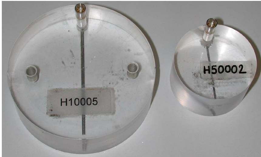
Abb. 3-45: Die Standard-Halbraumlinienquelle im Vergleich zur Mini-HLQ. Der Durchmesser des Probenhalbraums beträgt nur noch 50 mm, damit sind Vergleichsmessungen an identischen Proben mit gängigen stationären Meßapparaturen (Divided-Bar) möglich.
