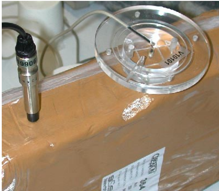
Abb. 3-14: Meßanordnung mit den Nadelsonden V19906 (Standardsonde) und V10101 (Gashydratsonde) in Töpferton. (s.a. Kapitel 4.2.2)
