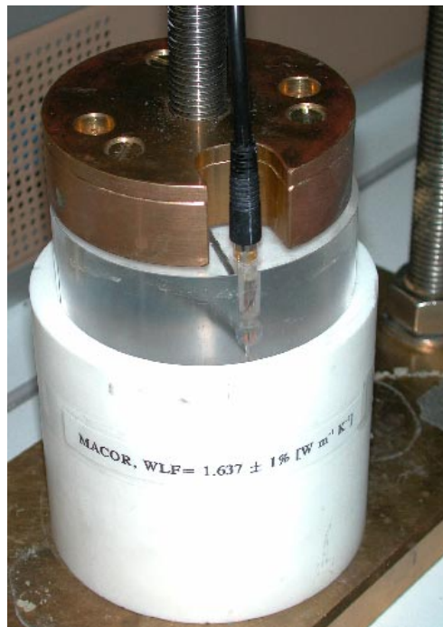
Abb. 3-41: Meßanordnung der Standard-HLQ im Labor. In einer speziellen Vorrichtung kann die Halbraumlinienquelle mit definiertem Anpreßdruck auf die Probe gepreßt werden.
