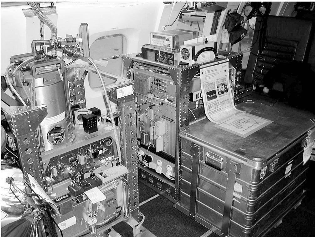
Abbildung 2.2: Das ASUR-Instrument eingebaut in die NASA DC-8 im Winter 1999/2000. Auf der linken Seite ist das *frontend*, auf der rechten Seite das *backend* zu sehen.
