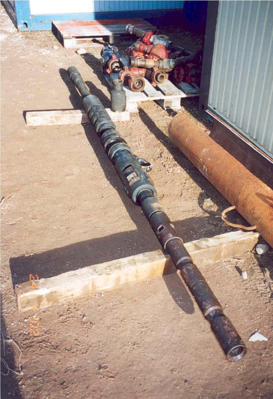
*Foto 1: Open hole Packer nach dem 1. Einsatz*
