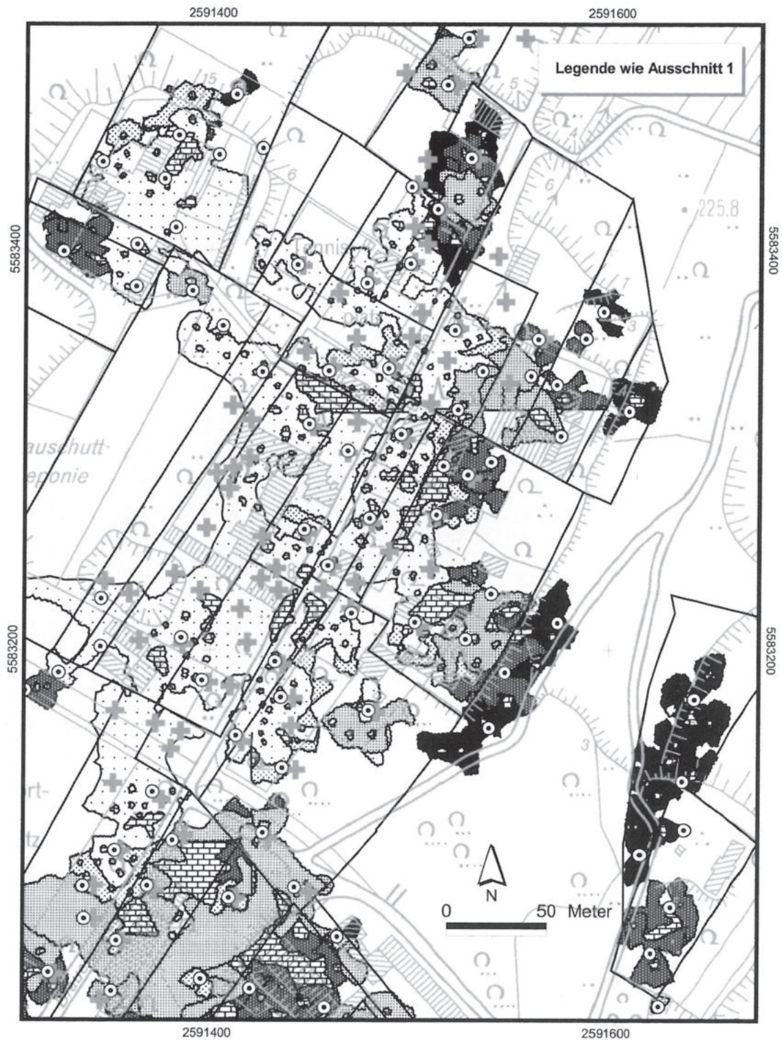
Abb. 7: Ausschnitt 2. Vergrößerter Ausschnitt der Abb. 5 mit Angabe der zeitlichen Entwicklung des untertägigen Basaltabbaus in den Jahren 1842 bis 1879 (Legende wie Abb. 6). (Geobasisinformation DGK 5 © Landesamt für Vermessung und Geobasisinformation Rheinland-Pfalz vom 18.12.2003 – Az.: 26 722-1.401).
