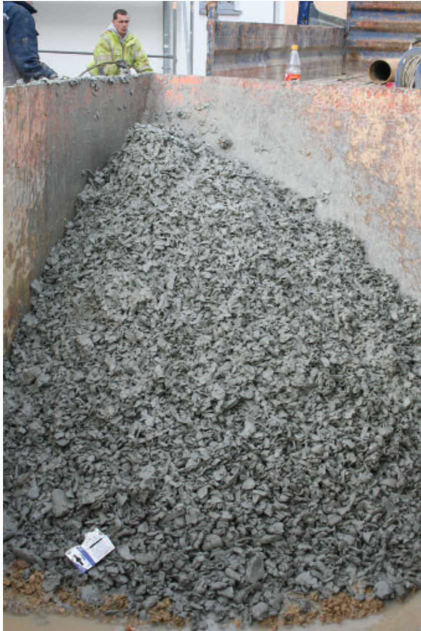
Abb. 3: Relativ gleichförmig ausgebildetes Bohrgut nach der Abscheidung aus der Spülung.
