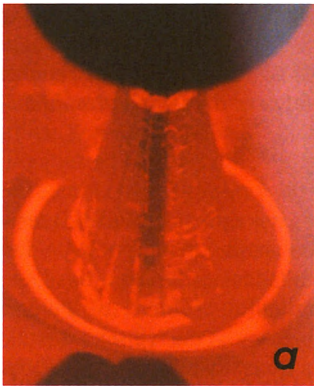
Abb. 6: Dekadogaler AlCoNi-Quasikristall, gezüchtet nach dem Czochralski-Verfahren durch Ziehen aus einer Al-reichen Schmelze. (a) Beim Züchten parallel [00001] kann die 10-zählige Symmetrie beobachtet werden; (b) derselbe Kristall nach der Entnahme.
