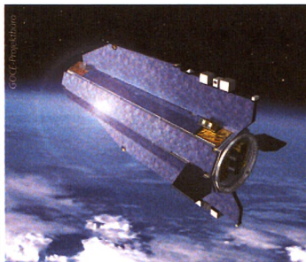
GOCE – Gravity Field and steady-state Ocean Circulation Explorer Start: März 2008 Orbit: 250 km Gewicht: ca. 1.000 kg
