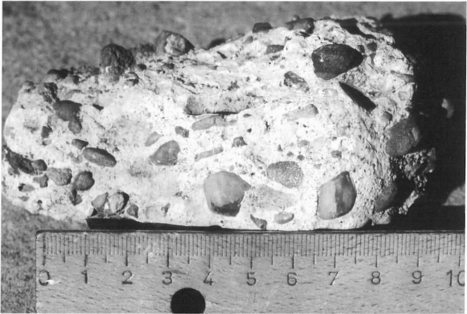
Abb. 4: Grenz dolomit (ku2G) in ardennischer Randfazies: Dolomit mit schwimmenden Quarz- und Quarzitzeröllen ("Naturbeton"; Foto aus TAPP 1999).
