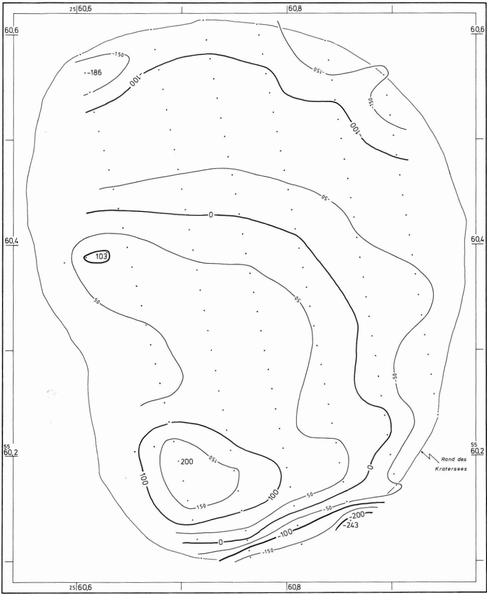
Abb. 11: Isanomalenplan der Totalintensität des Kratersees des Weinfelder Maares.
