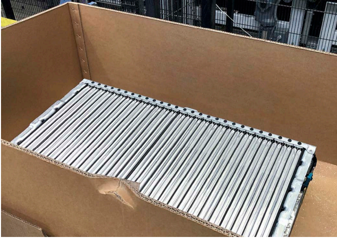
Abb. 8: Schadhafte Lithium-Ionen-Pkw-Batterie, die zum Recycling vorbereitet wurde. Derzeit werden nahezu ausschließlich Fehlproduktionen oder Akkus aus Unfallfahrzeugen recycelt, da der überwiegende Teil der Lithium-Ionen-Batterien ihren Nutzungszyklus noch nicht vollendet hat (Foto: G. Borg).
