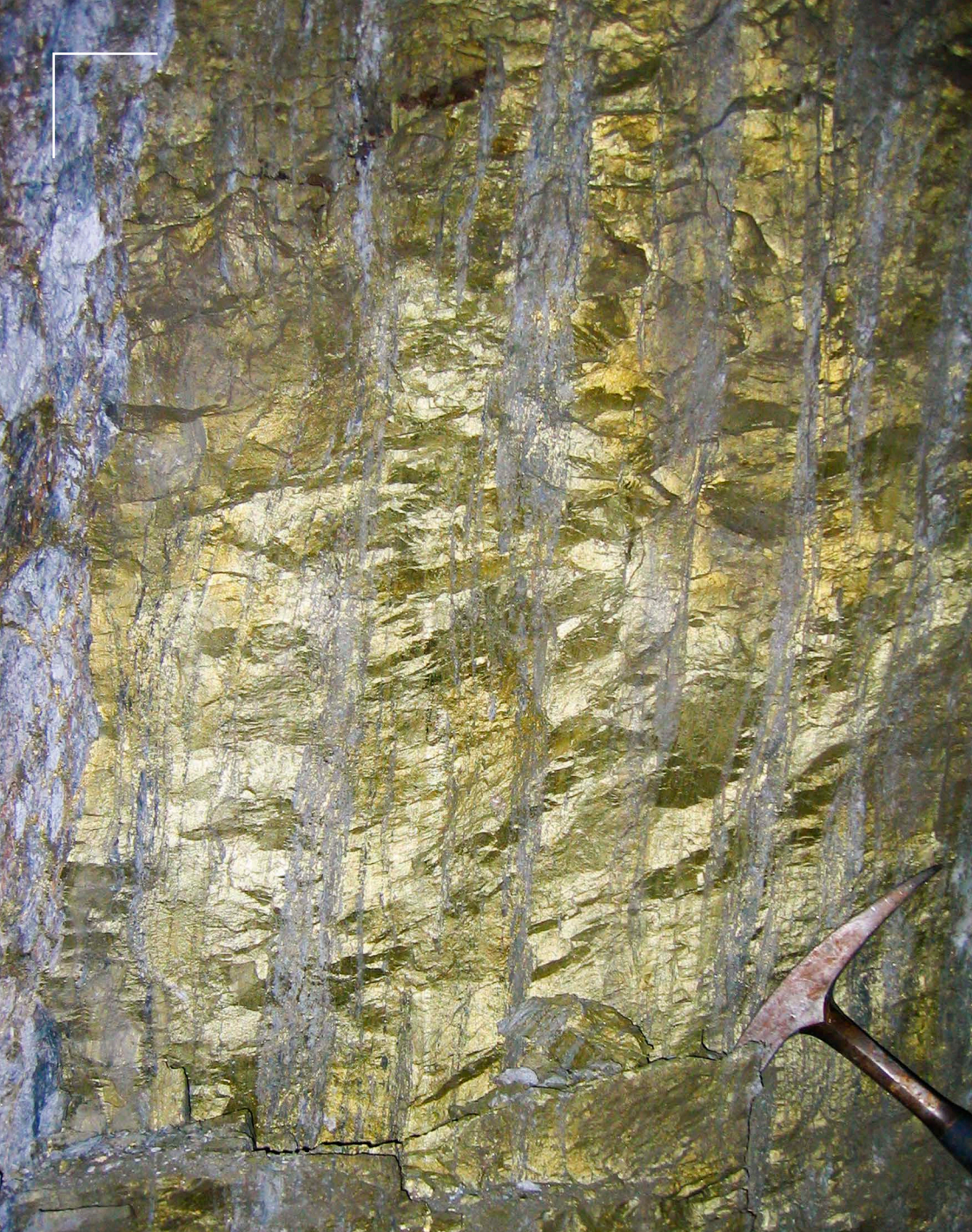
Tektonisch vertikal verstelltes vulkanogenes Massivsulfiderz der Neves-Corvo-Lagerstätte im Süden Portugals. Die Neves Corvo Mine ist Teil des iberischen Pyritgürtels und eines der bedeutendsten Kupferbergwerke Europas. Deutlich sichtbar sind das chalcopyritreiche (goldgelb, Mitte und rechts) und das bornitreiche (violett, links) Erz (Foto: G. Borg).
