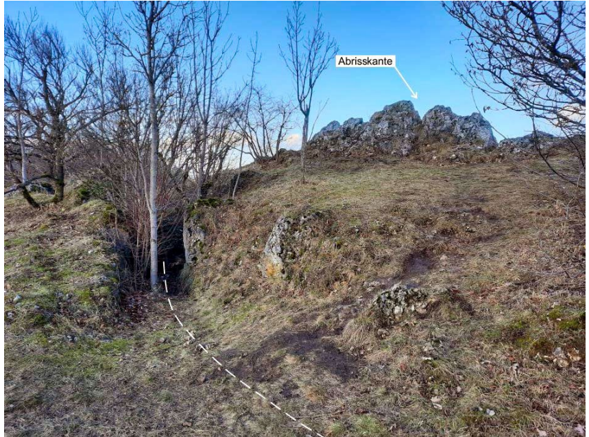
Abb. 29: Beginnende Ablösung einer Festgesteinscholle an einer 1,20 m breiten Zerrspalte hinter der Hauptabbrisskante der Massenbewegung SE_2. (Blickrichtung: NW; Position: R: 655692 H: 5509318).
