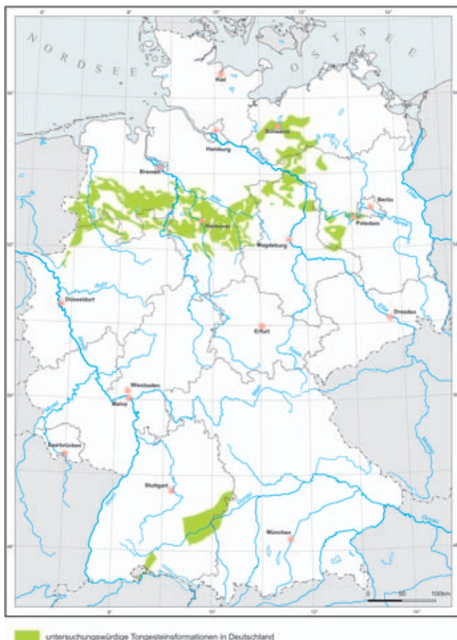
Abb.3: Untersuchungswürdige Tongesteinsformationen für die Endlagerung hochradioaktiver Abfälle in Deutschland (HOTH et al. 2007)
