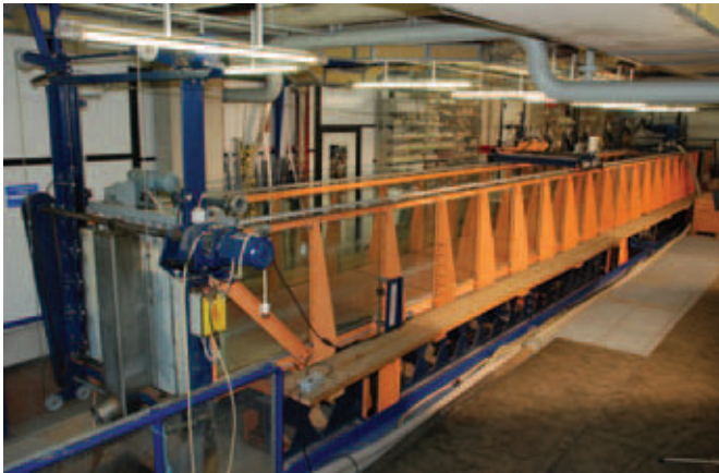
Abb. 1: Die neigbare Messrinne des 20-m-Strömungs- und Wellenkanals. Die Pumpen und Rohrleitungen befinden sich unter den Stahlrosten. Links: Ende der Messrinne mit Wehr und Probennehmer. Die vom vertikalen Schlitzsandfang aufgenommene Probe wird in einen Tank unter den Hallenboden geleitet, getrocknet und gewogen.
