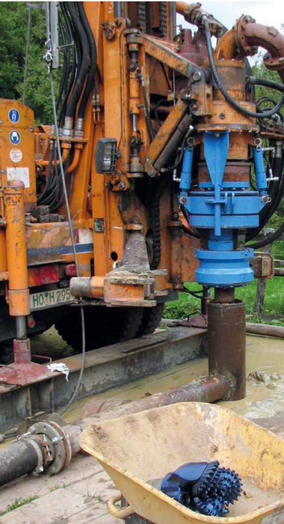
Ein solider Rollenmeißel wurde für die Vulkanite unterhalb der Sedimentfüllung in den Bohrkopf eingebaut. Die Forschungsbohrung Rodderberg erreichte ihre Endteufe bei 164 m (Foto: F. Binot).
