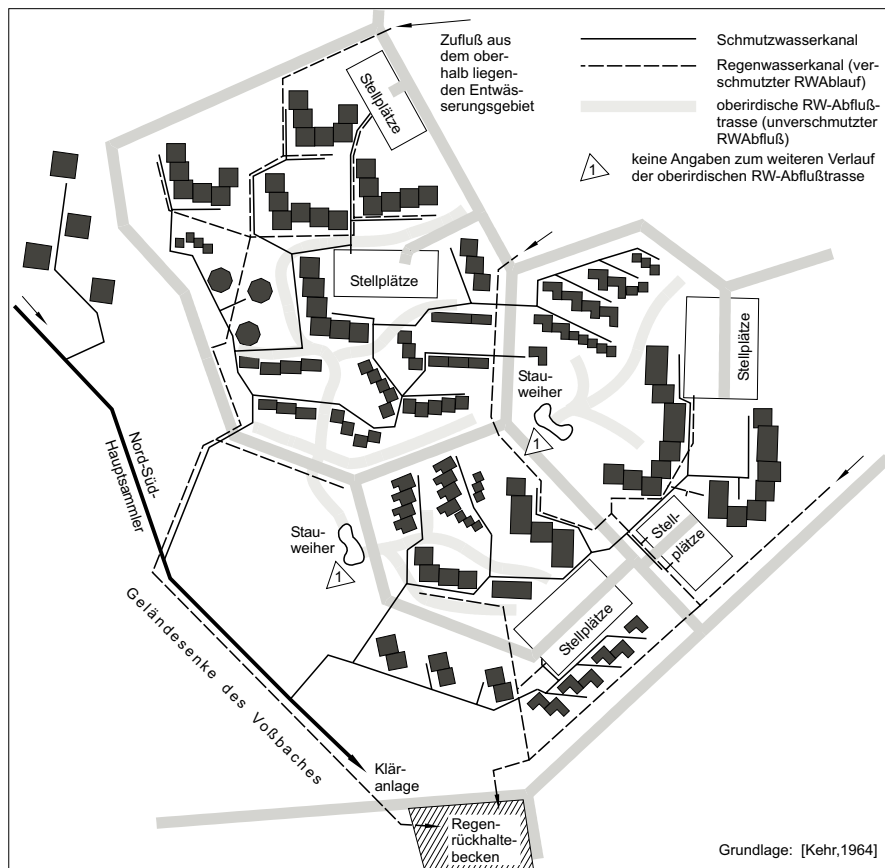
Abb. 40 Erster Musterentwurf zur Entwässerung von Kehr, Mai 1964 (Analyse und Überlagerung der Originalpläne aus [Kehr, 1964])
