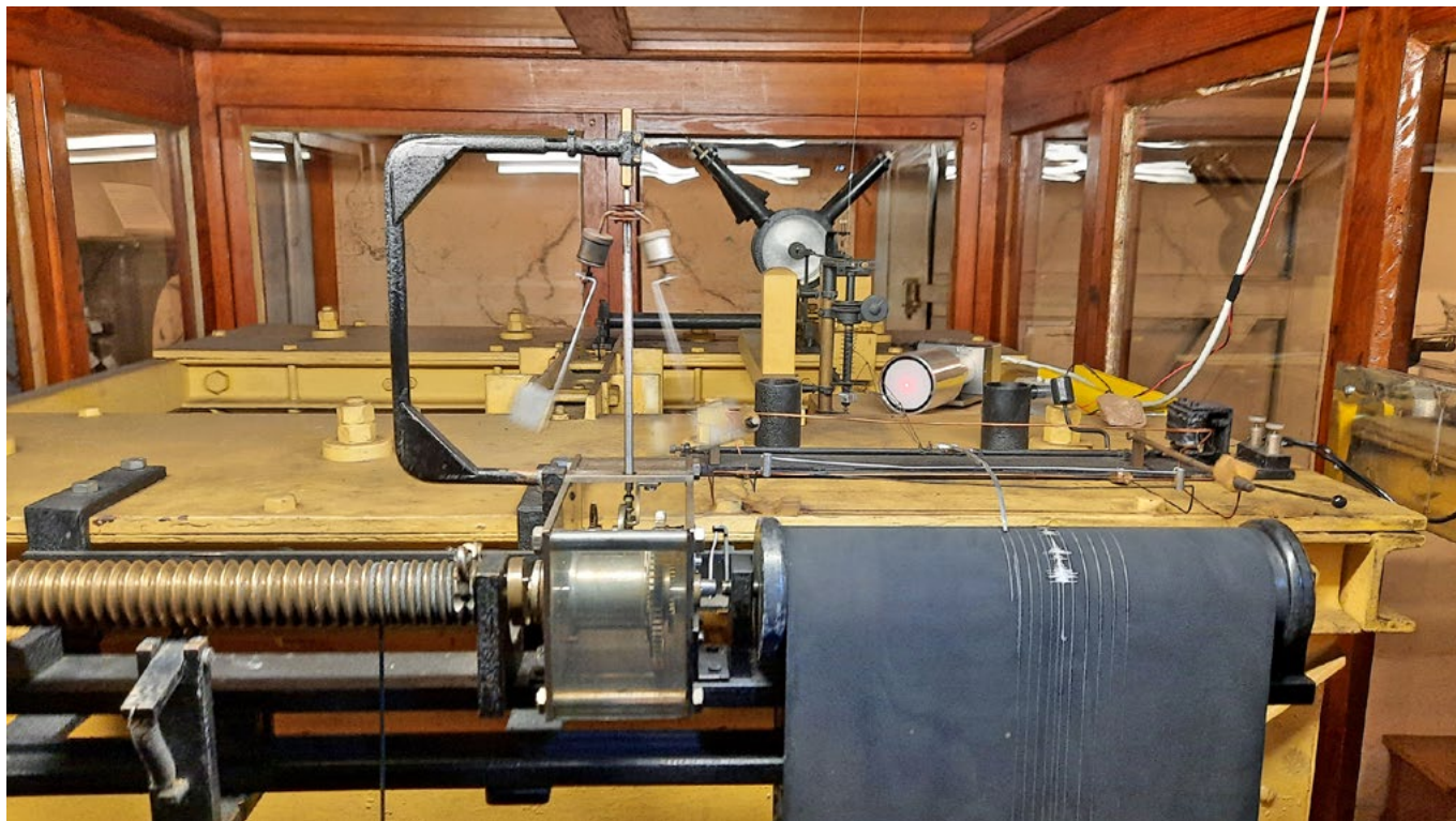
Abb. 2: Astaticher Vertikalseismograph von Wiechert, Göttinger Station GTT-Z (Foto: P. Schmitt)
